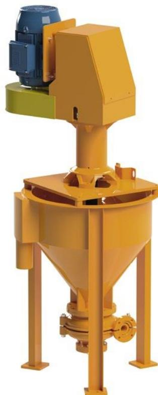
**Описание:** вертикальный центробежный насос, погружаемый ниже уровня перекачиваемой жидкости. Используется для перекачки абразивных или агрессивных пенных растворов.
