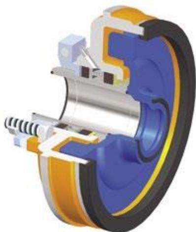
Сочетание рабочего колеса и выталкивателя создает давление, необходимое для герметизации от протечки. Вместе с сальниковым или манжетным уплотнением, которые используются в качестве перекрывающего уплотнения, центробежное уплотнение может удовлетворять требования по уплотнению в случаях, когда сальниковое уплотнение с полной промывкой является непрактичным по причине отсутствия воды или уплотняющая вода может поступать внутрь насосной камеры для разбавления шлама.
